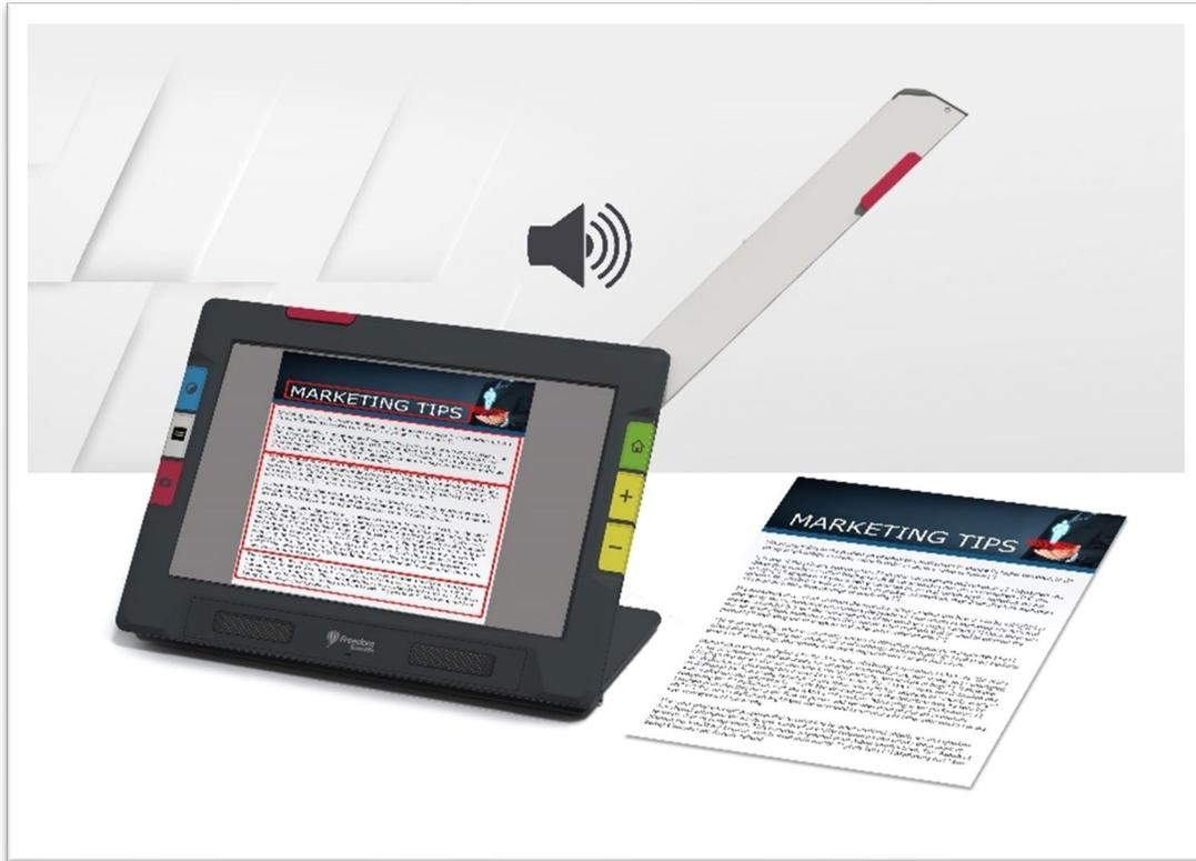
Cuando el brazo de la cámara y el soporte están desplegados, la cámara puede utilizarse para leer y escanear documentos o para firmar sin que sus movimientos se vean limitados. Esta cámara también puede utilizarse para aficiones como la pintura.
