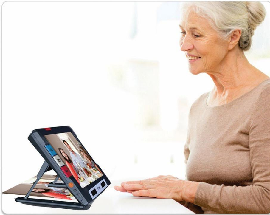
Cuando el soporte está abierto y el enfoque no es fijo, la cámara estabiliza la imagen automáticamente. Si no se detecta ningún movimiento, la imagen se congela para facilitar la lectura.
