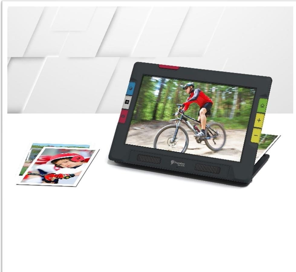
La cámara de ampliación se utiliza para leer en una mesa o escritorio. Debe colocar el dispositivo sobre el material de lectura, cerrando el brazo y desplegando el soporte. En este modo, la luz está siempre activa para compensar la oscuridad bajo el dispositivo.
